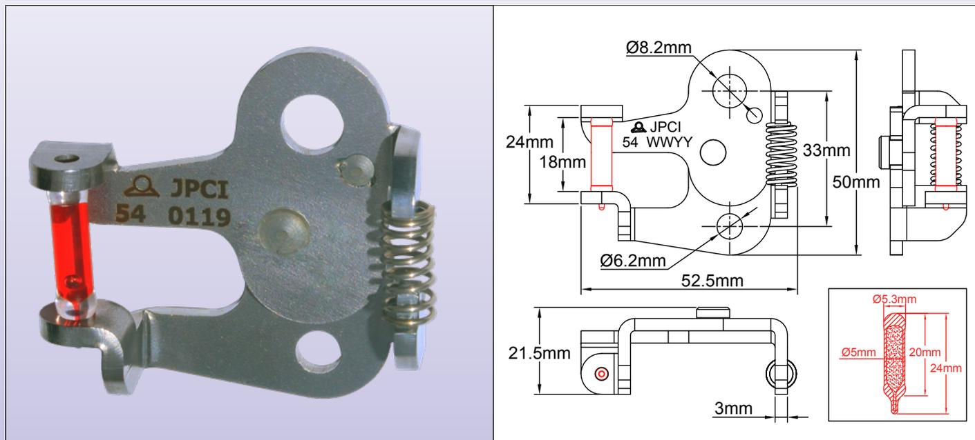
Réalisés en acier zingué de 3mm d'épaisseur, ces mécanismes démultiplicateurs sont compatibles avec les bulbes thermo-frangibles de 5 x 20mm. En raison de leur important coefficient de démultiplication, la force appliquée sur le bulbe en verre est seulement 15% de celle appliquée sur le mécanisme. Le remplacement des bulbes est simple et peut se faire sans outillage spécial.
